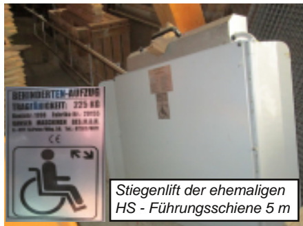
Schalt- u. Steuerschrank E: 1,3 x 1 x 0,26 m
